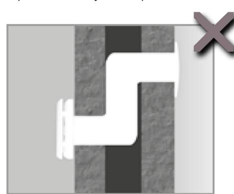
breve canalizzazione (inferiore a 1,5m) - short length ducting (less than 1,5m)
