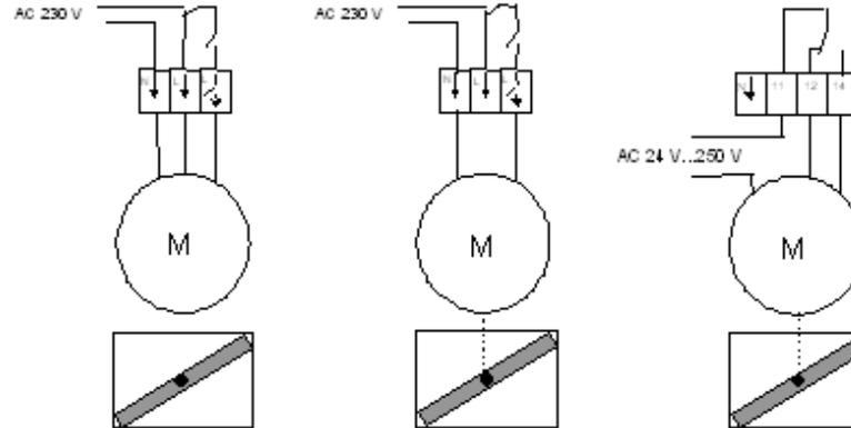
**Français****Exemples de raccordement moteur pour le positionnement de clapets**
