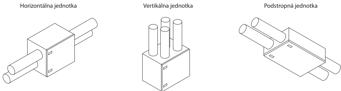
Obr. 1. Klasifikácia jednotiek podľa potrubných pripojení
